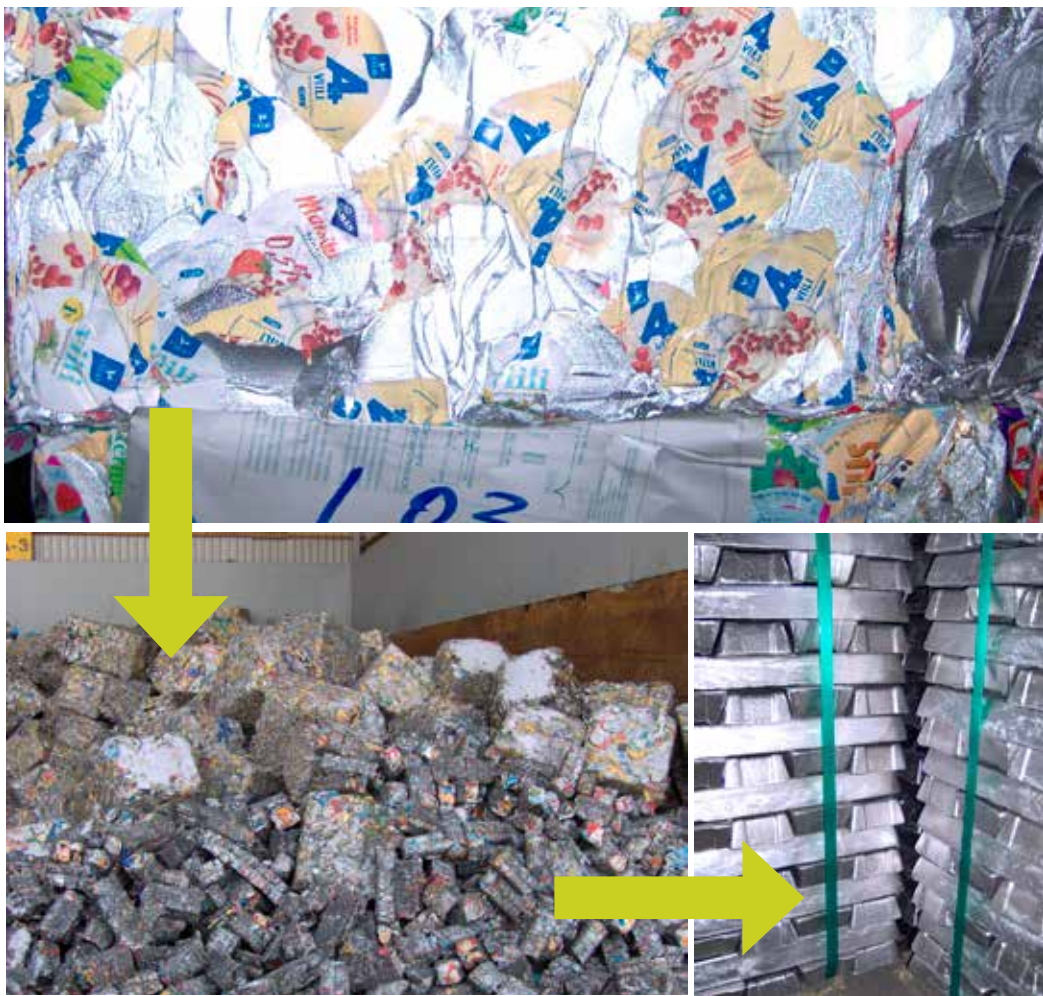
Kuva 11. Alumiinin kierrätystä Kuusakosken Heinolan alumiinisulatossa, joka on Suomen ainoa alumiinisulatto ja valmistaa alumiiniharkkoja kierrätysalumiinista. (Kuvat: Petri Pakkanen)
